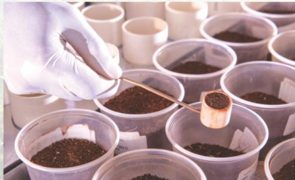
Processo de amostragem denominado de Cachimbagem. Tomada de um volume de solo, uma vez que, em análises de solo não se pesam as amostras e sim toma-se um volume.
