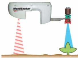
Sensor óptico eletrônico que determina se uma planta daninha está presente e uma válvula solenóide rápida que adiciona o bico para a pulverização localizada.
