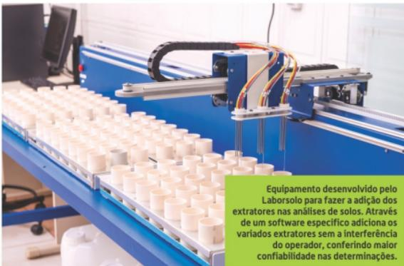
Equipamento desenvolvido pelo Laboratório para fazer a adição dos extratores nas análises de solos. Através de um software específico adiciona os variados extratores sem a interferência do operador, conferindo maior confiabilidade nas determinações.
