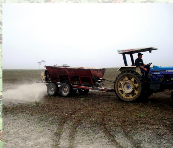
Acima, o modelo convencional de aplicação com equipamento de taxa fixa, ajustado manualmente e com pouca versatilidade
